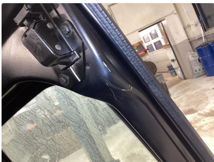
1.2 Bulk(er) med lakkskade
