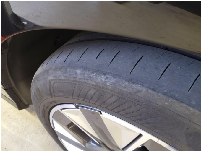
1.1 Skjev slitasje på sommerdekk
