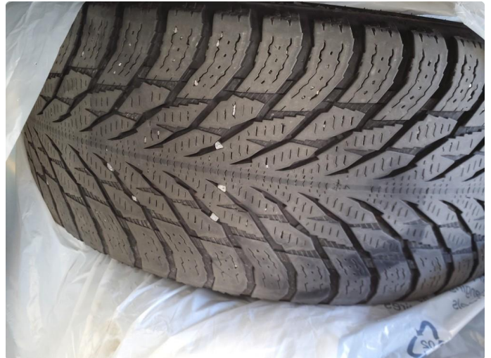
1.2 Skjev slitasje på vinterdekk
