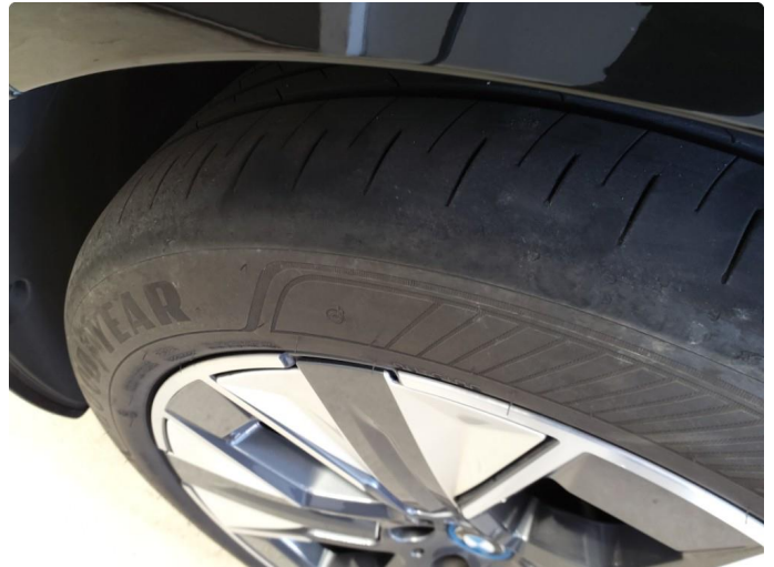
1.1 Skjev slitasje på sommerdekk
