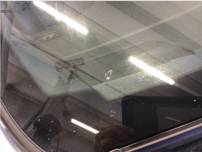
2.15 Steinsprut,men er fylt
