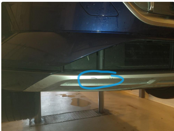
1.5 Ripe(r) ned til grunning
