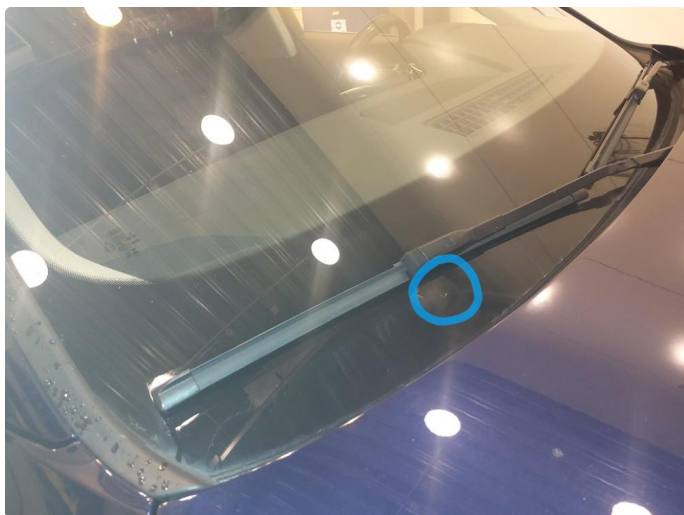
1.6 Steinsprut med sprekk
