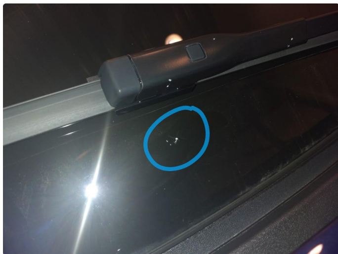
1.6 Steinsprut med sprekk
