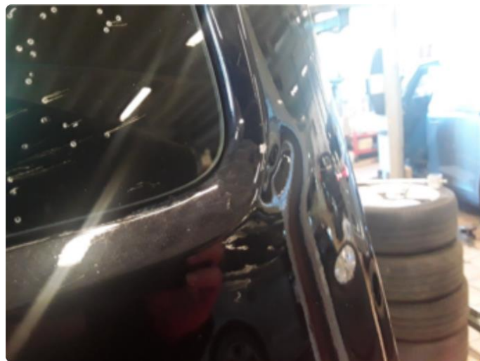
1.1 Div. lakkriper, småbulker og steinsprut med korrosjon.
