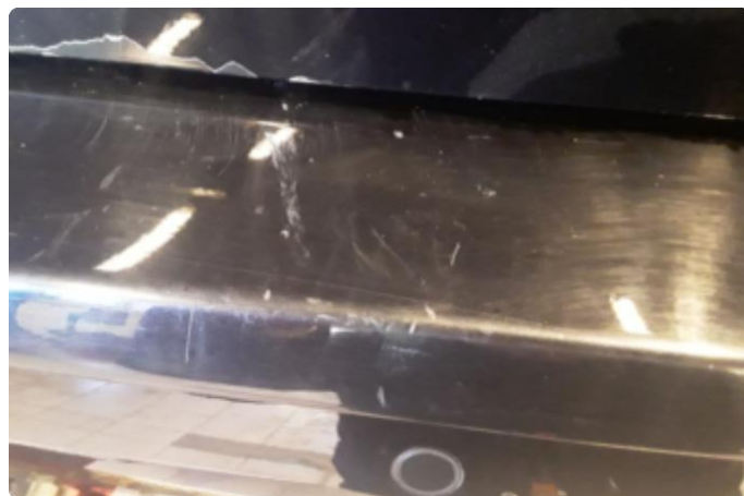
1.1 Div. lakkriper, småbulker og steinsprut med korrosjon.
