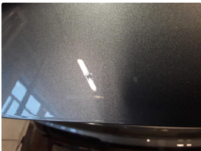
1.4 Liten steinsprut med korrosjon.
