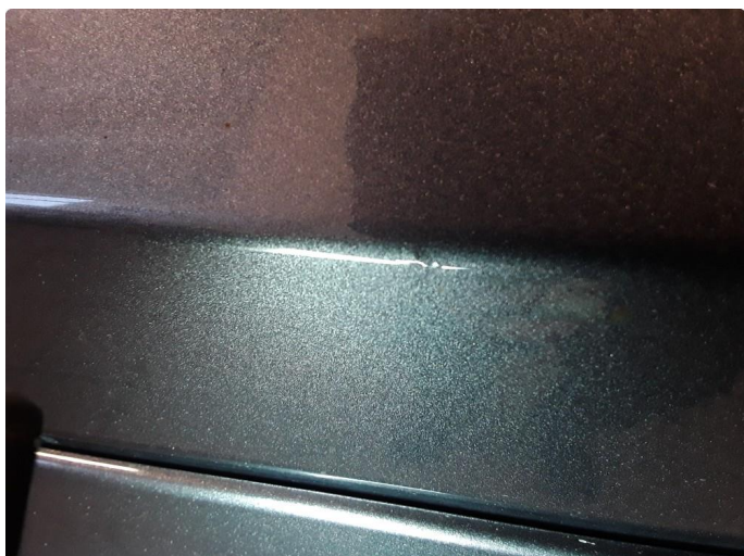
1.2 Liten steinsprut med korrosjon.
