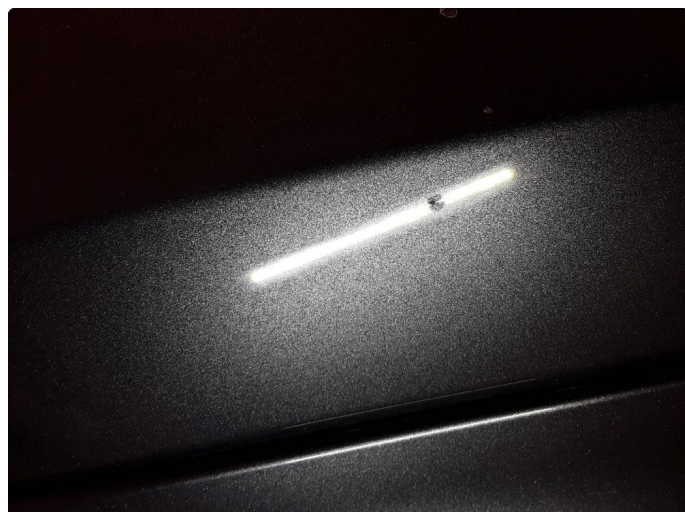
1.3 Liten steinsprut med korrosjon.
