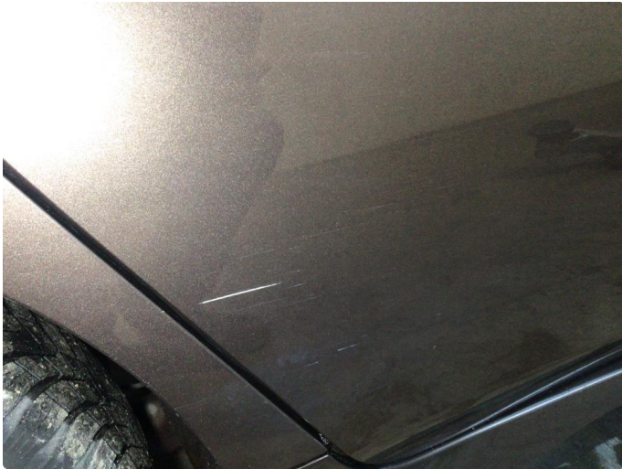
1.1 Noe overfladiske riper ved høyre bakhjør/bakskjerm, dette av ubetydelig karakter
