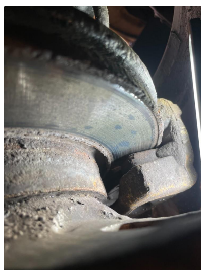
2.1 Slitte/stor slitekant, blir byttet 9/3-26
