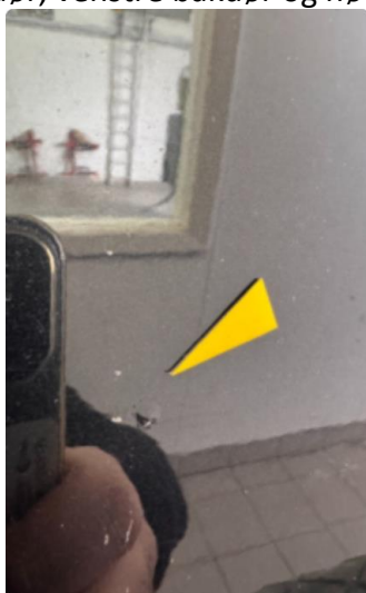
1.1 Noen små steinsprut med korrosjon på venstre fordør, venstre bakdør og høyre bakdør.
