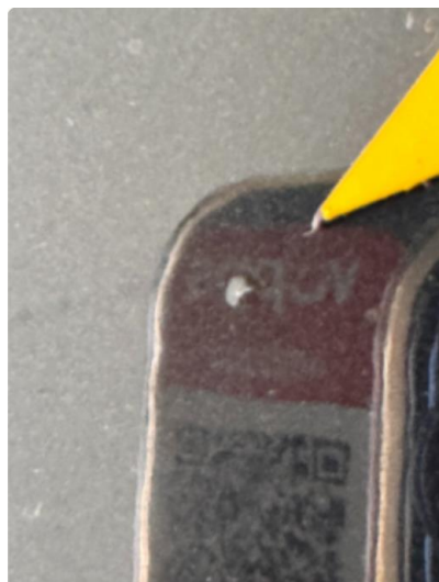
1.1 Noen små steinsprut med korrosjon på venstre fordør, venstre bakdør og høyre bakdør.
