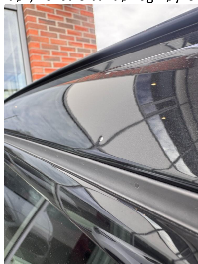
1.2 Liten bulk høyre takvange. Blir forsøkt med bulkfix.
