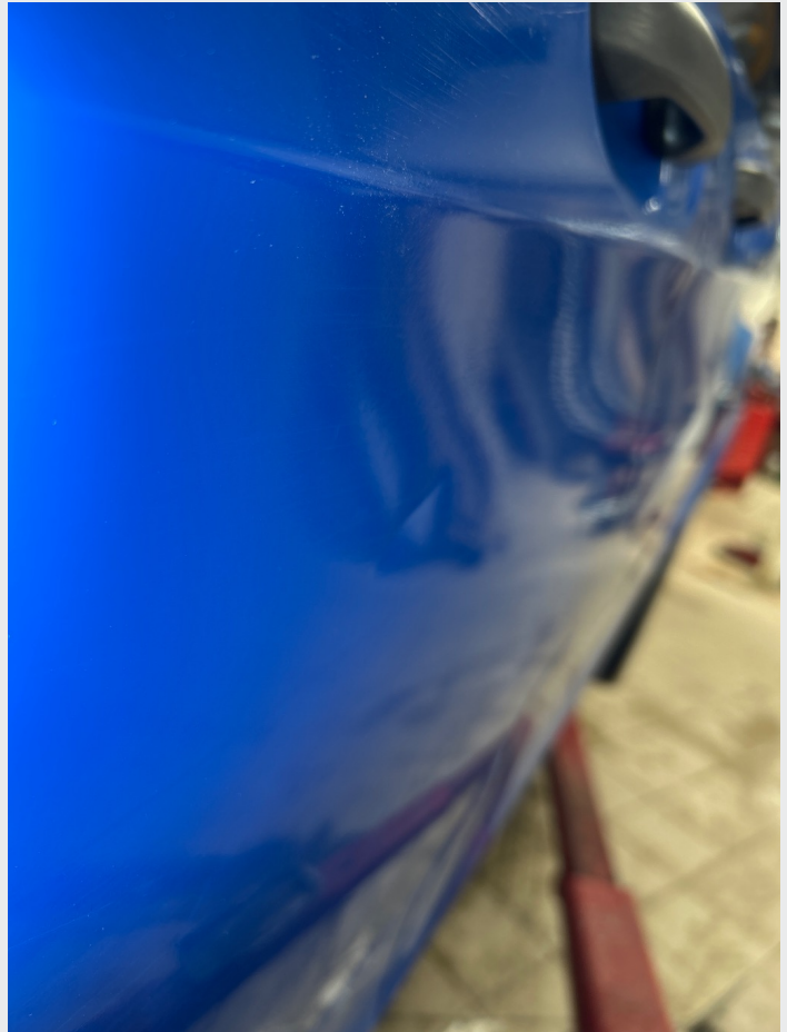
2.1 Noe bulker og småskader
