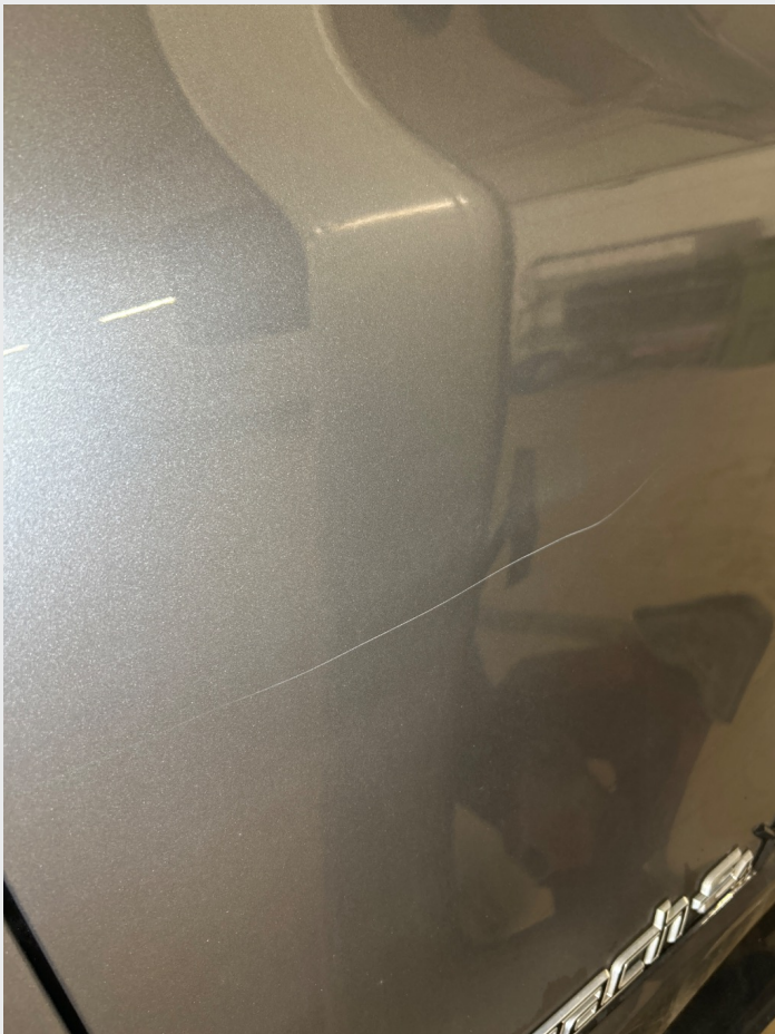
2.1 Noe riper og steinsprut rundt om
