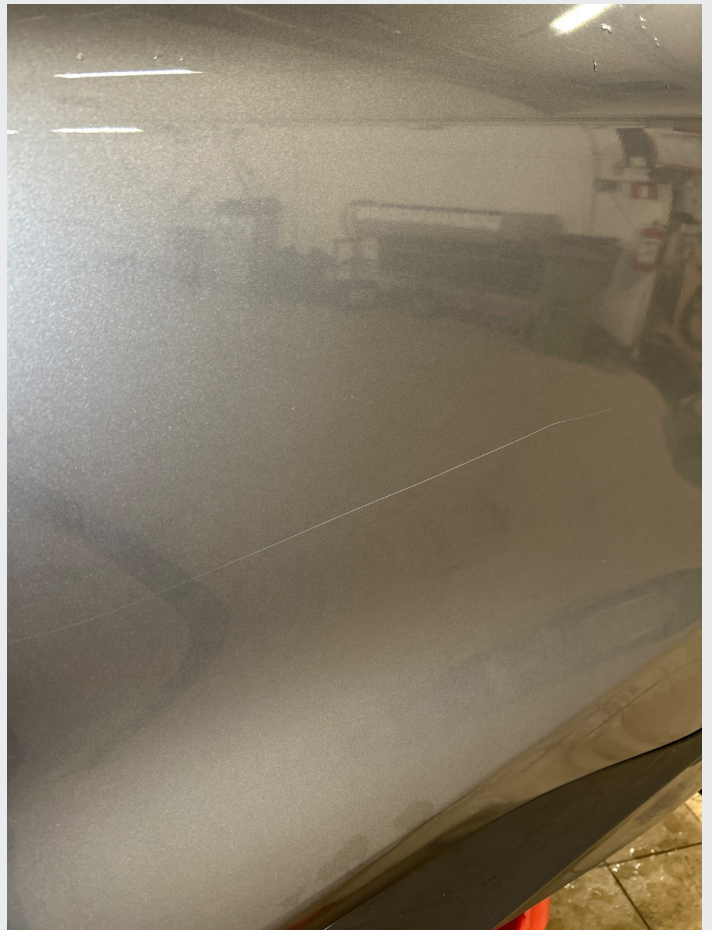
2.1 Noe riper og steinsprut rundt om
