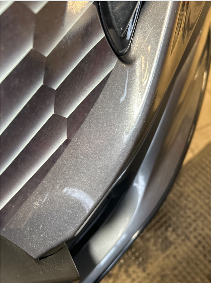
2.1 Noe riper og steinsprut rundt om
