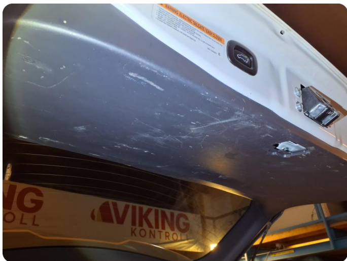
7.1 Øvrige feil Noen riper og flekker interiør
