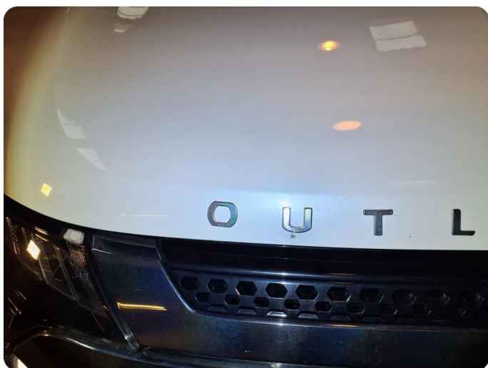
3.1 Generelt mye stensprut Og riper
