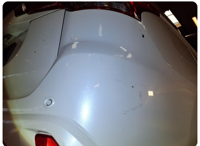
3.1 Generelt mye stensprut Og riper
