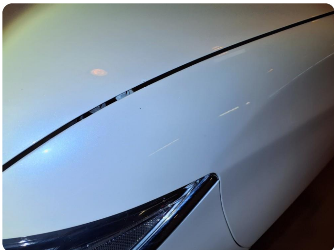
3.1 Generelt mye stensprut Og riper
