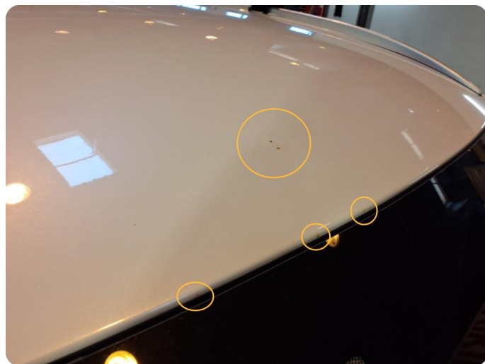
3.4 Steinsprut med rust
