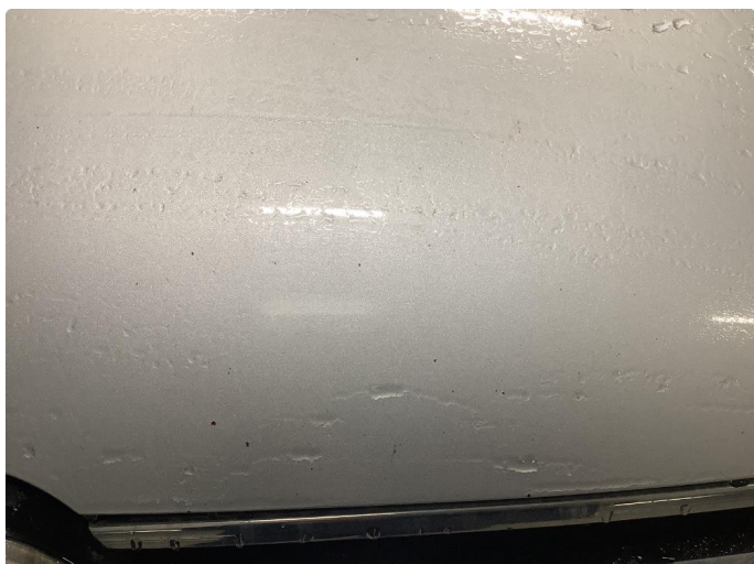
1.1 Noe steinsprut med rust
