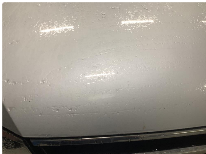
1.1 Noe steinsprut med rust
