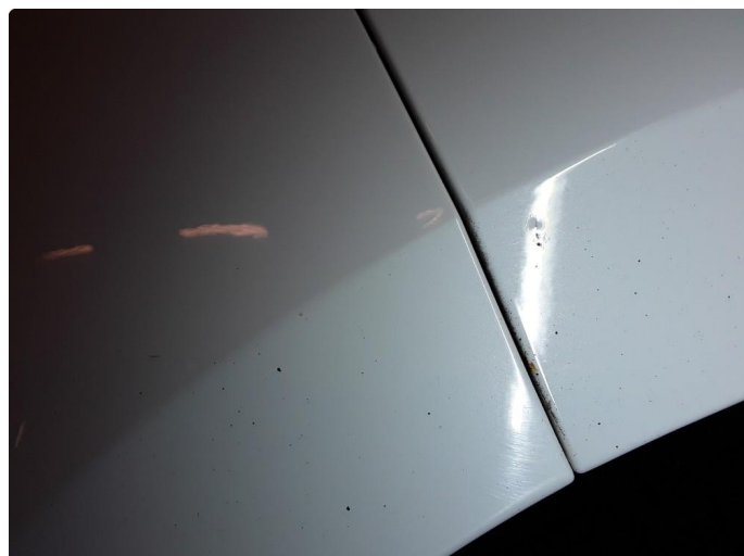
1.3 Liten steinsprut med korrosjon.
