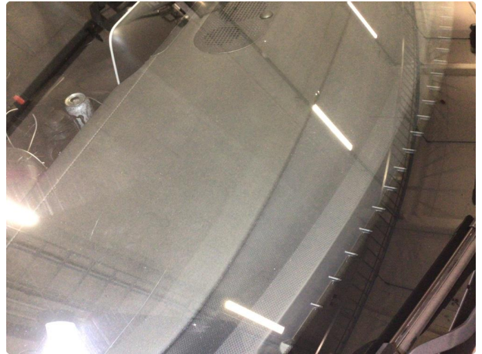
1.3 Noe steinsprut på frontvindu
