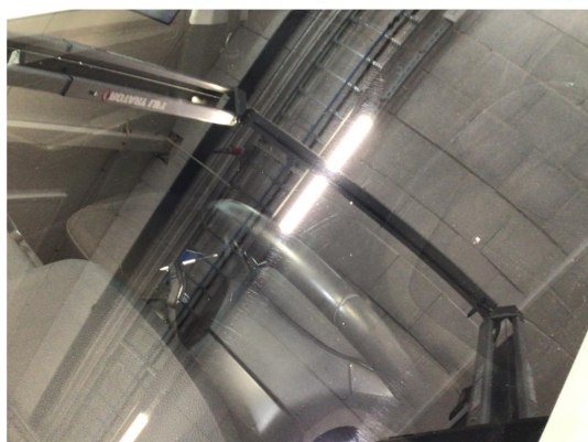
1.2 Noe steinsprut på frontvindu, en knast er limt
