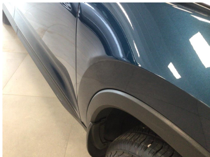
1.1 Liten bulk på høyre framskjerm blir utbedret
