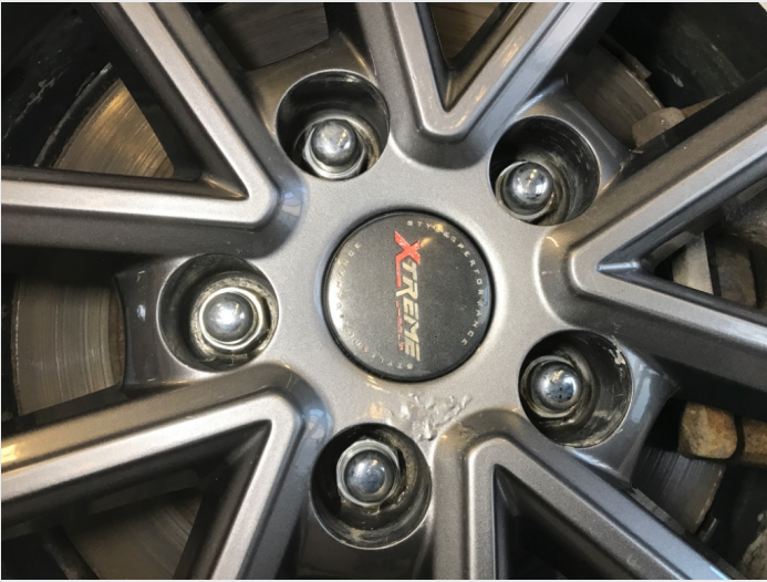
2.18 Litt korrosjon på alle vinterfelger.
