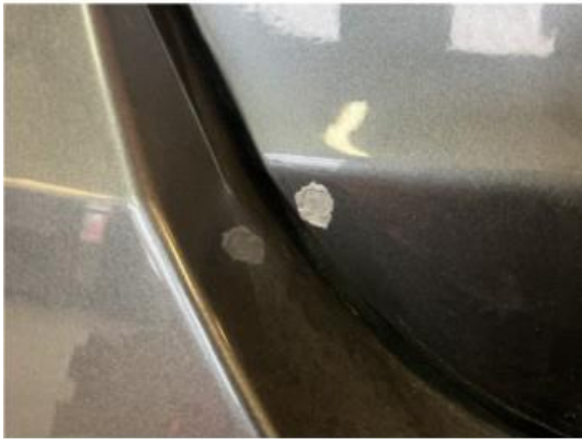
1.1 Liten lakkskade bakluke
