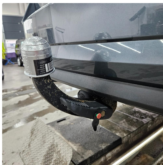
1.3 Låsesylinder defekt på avtagbart h.feste, bilen selges med "fastmontert" tilhengerfeste
