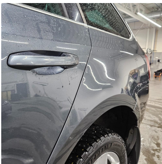
1.2 Noen små park.bulker
