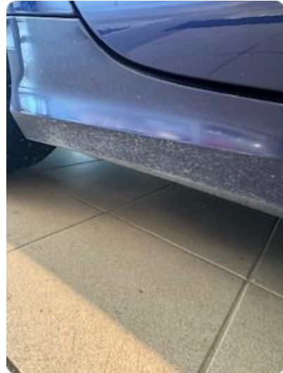
1.3 Steinsprang, normalt etter alder og km på kanaler høre og venstre
