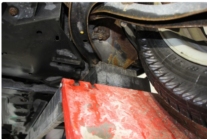
2.2 En hel del rust i chassis, ser også en del rust i dempertårn foran. Kjente ett mykt punkt i rammevange høyre bak.
