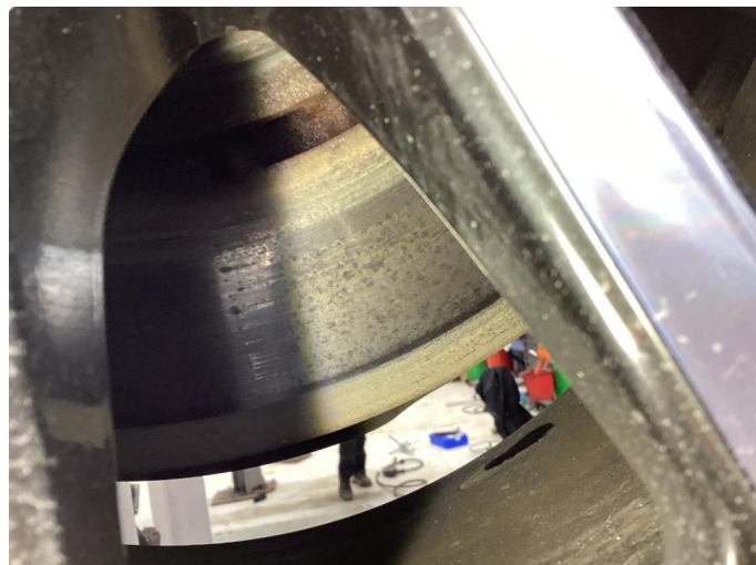
1.1 Noe rustflekker skiver foran. BREMSENE KJØRES RENE NÅR BILEN TAS I BRUK.
