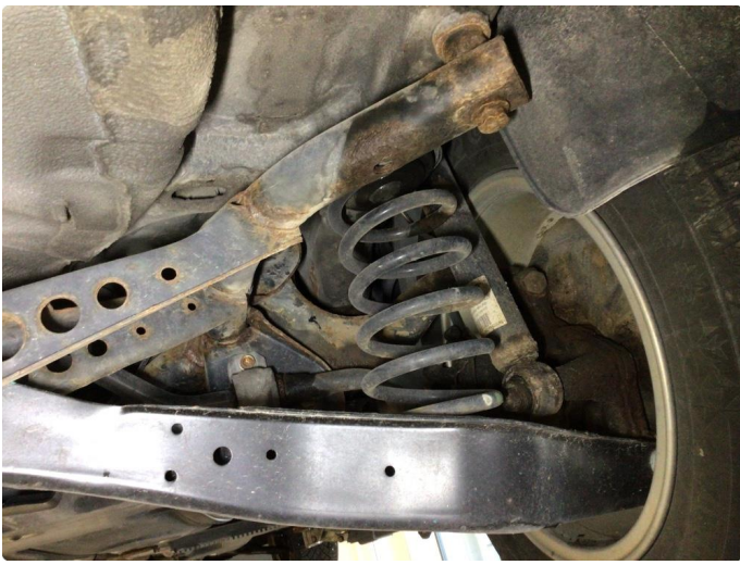
3.2 Overflaterust i bakstilling, ingen tiltak kreves
