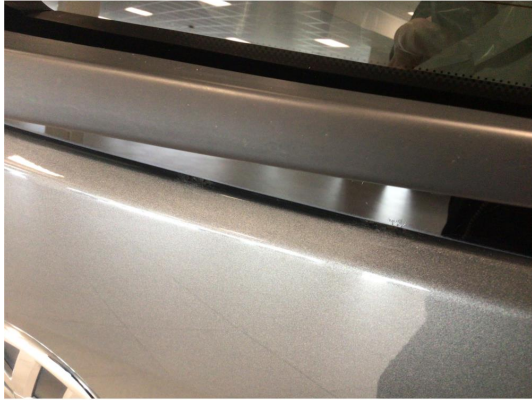
1.1 Noe overfladisk med korrosjon i enden av kanaler begge sider, hjulbuer bak, bakluke og venstre bakdør, dette av minimalt omfang og må regnes som normal bruksslitasje for en eldre bil
