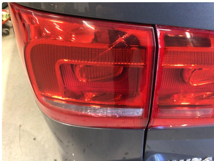
2.1 Noe krakelering i baklykter, dette av mindre betydning
