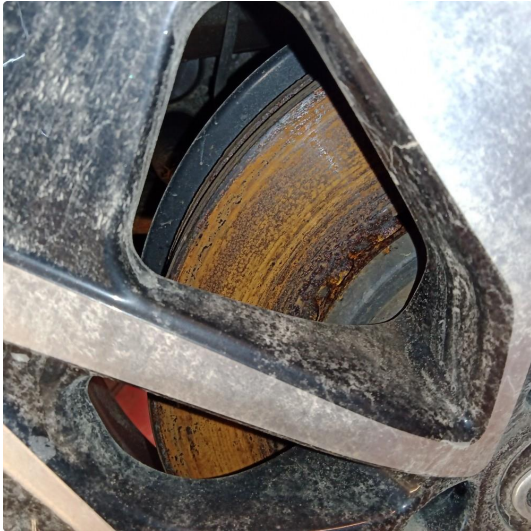
1.1 Rust. KJØRES RENE NÅR BILEN TAS I BRUK.
