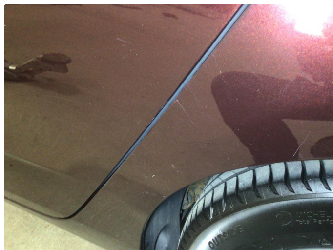
1.1 Noe overfladiske riper rundt på bil, litt korrosjon i bakre ende av kanal begge sider, dette må regnes som normal slitasje på en eldre bil
