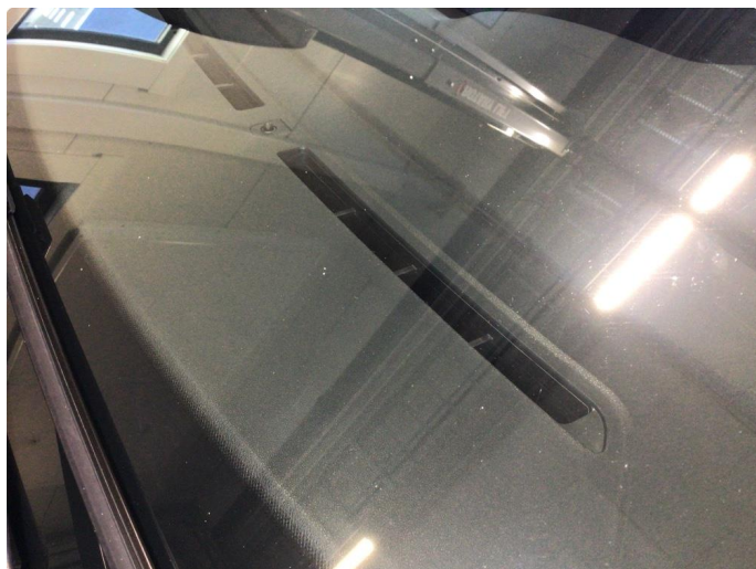
1.6 Noe steinsprut på frontvindu
