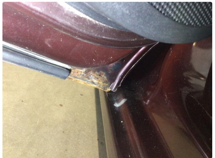
1.3 Korrosjon i nedre del av begge bakdører
