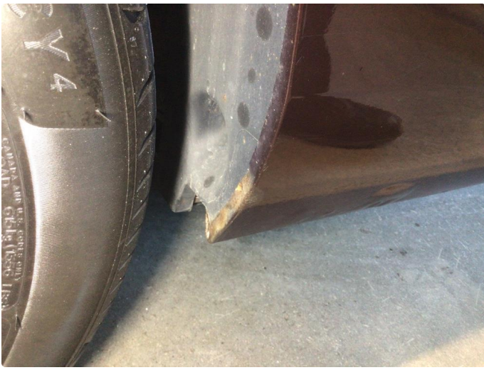
1.1 Noe overfladiske riper rundt på bil, litt korrosjon i bakre ende av kanal begge sider, dette må regnes som normal slitasje på en eldre bil
