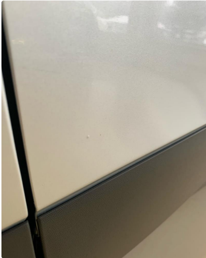
1.2 Liten steinsprut med korrosjon venstre fordør.
