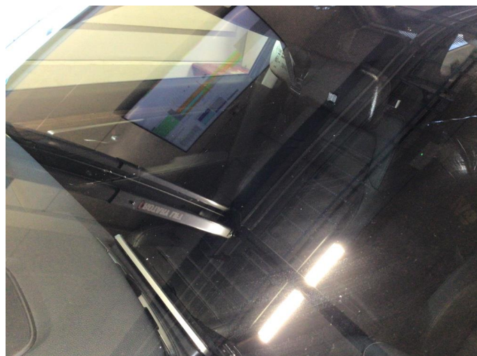
1.1 Noe steinsprut på frontvindu
