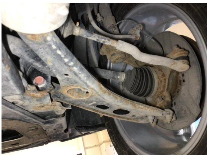
2.1 Overflaterust i forstilling, ingen tiltak kreves
