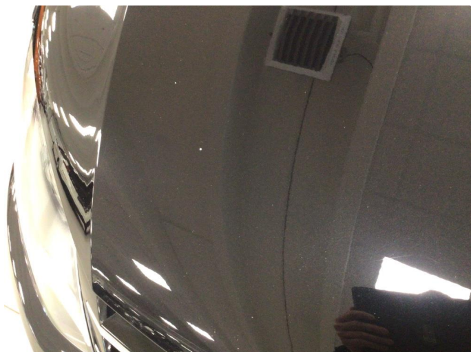
1.1 Steinsprut på panser
