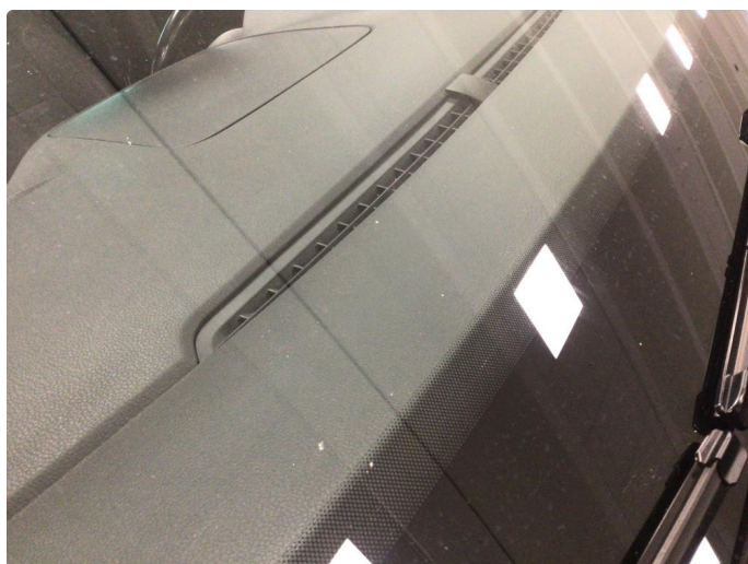
1.3 Steinsprut på frontvindu
