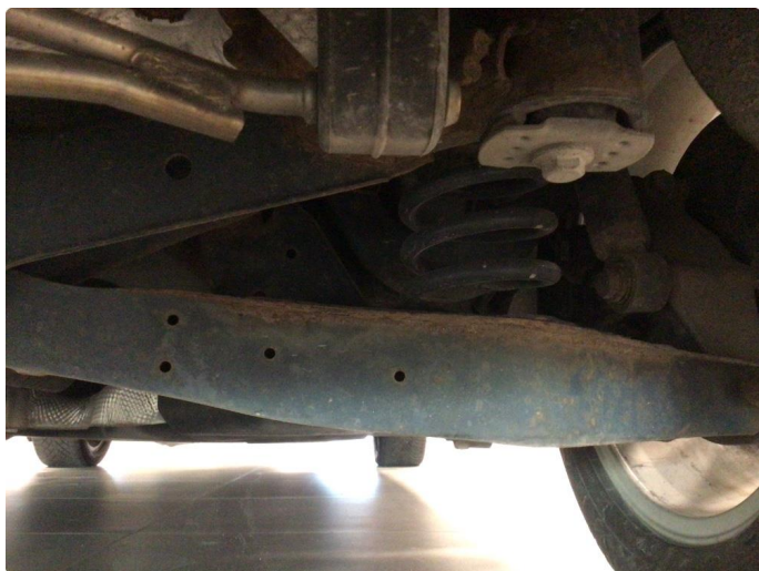
2.1 Overflaterust i bakstilling, ingen tiltak kreves
