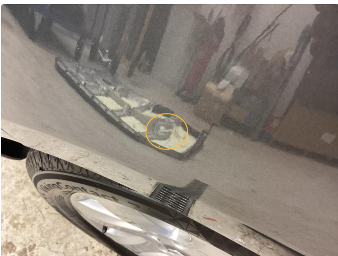
1.4 Bulk med lakkskade
