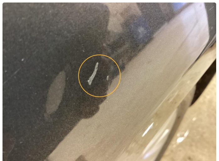
1.4 Bulk med lakkskade
