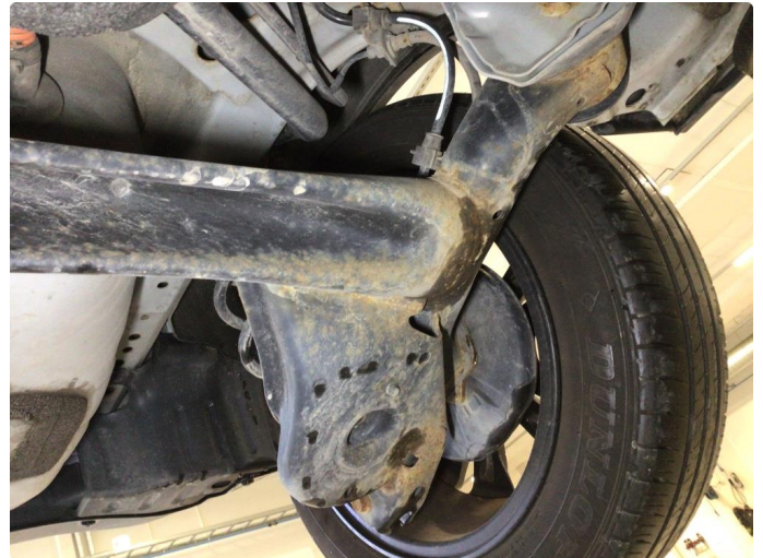
2.1 Overflaterust i bakstilling, ingen tiltak kreves
