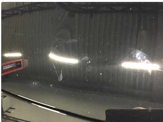
1.1 Noe steinsprut med rust
