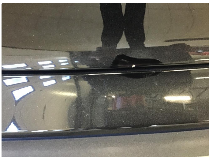
1.3 Steinsprut med rust
