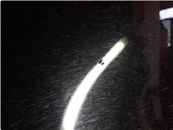
1.2 Liten steinsprut med korrosjon.
