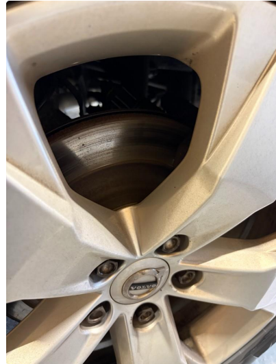
3.1 Bremsar bak byttet
