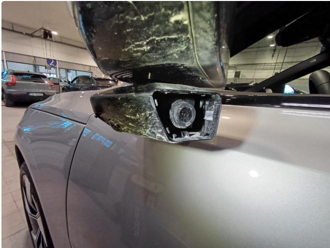
1.1 Stensprut i front og slitasje merke
