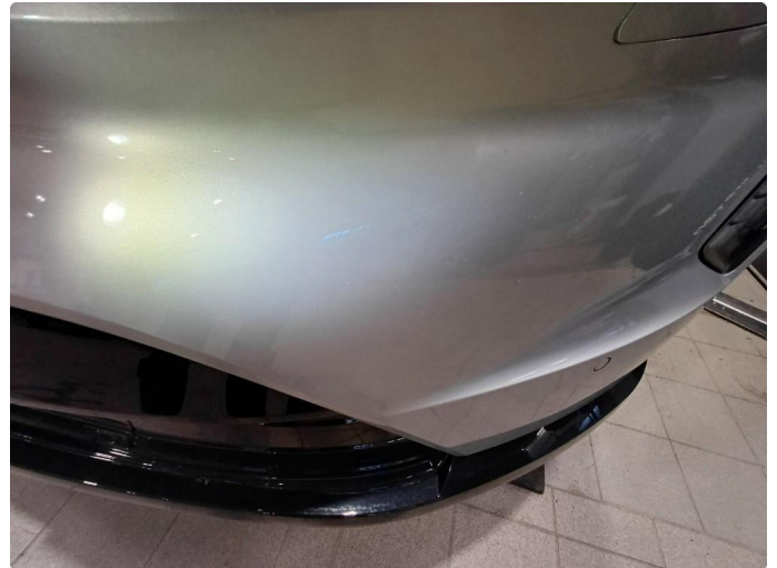
1.1 Stensprut i front og slitasje merke
