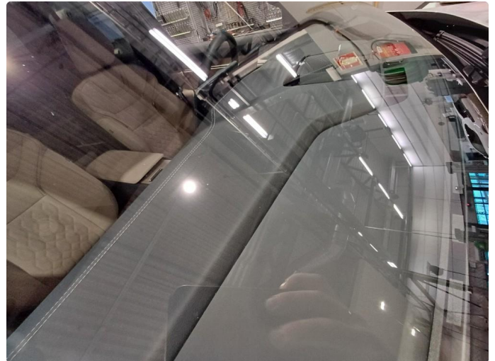
1.1 Stensprut i front og slitasje merke
