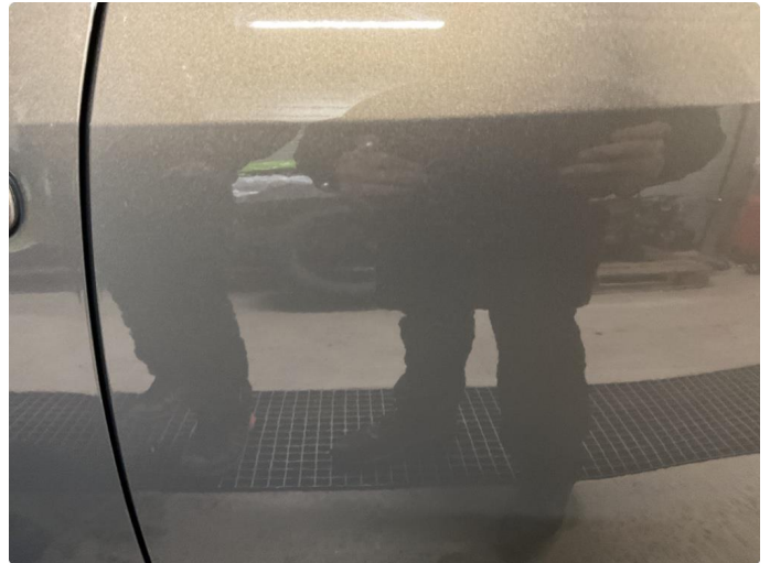
1.2 Bulk/lakkskade . Utbedres med smart repair. Pris kr. 4.160,-
