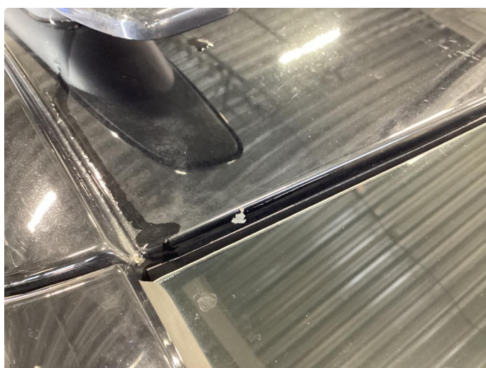
1.8 Steinsprut med rust
