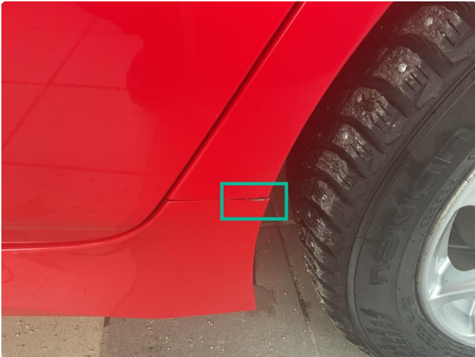
1.1 Lakk er slitt ved skøyt.
