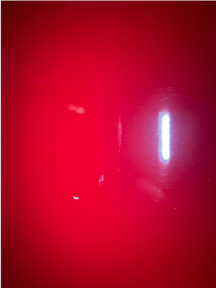
2.1 En del steinsprut og riper rundt om
