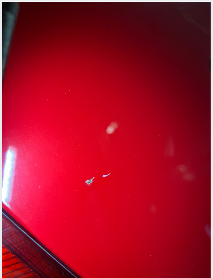
2.1 En del steinsprut og riper rundt om
