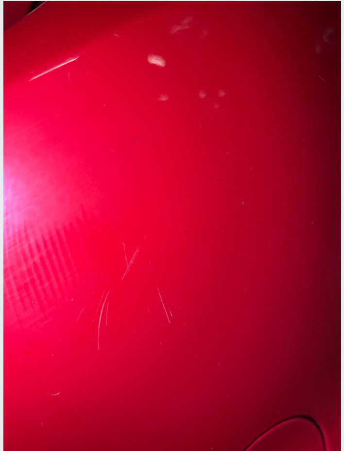
2.1 En del steinsprut og riper rundt om
