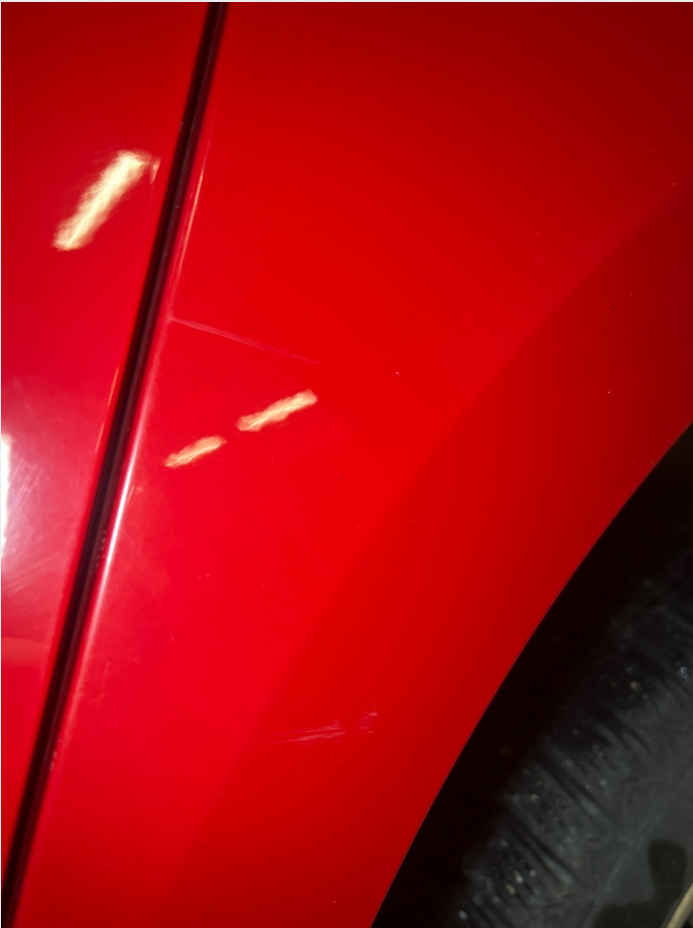
2.1 En del steinsprut og riper rundt om
