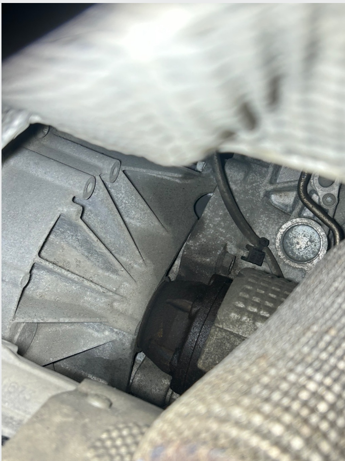
7.1 Svetting simmering girkasse - drivaksel begge sider
