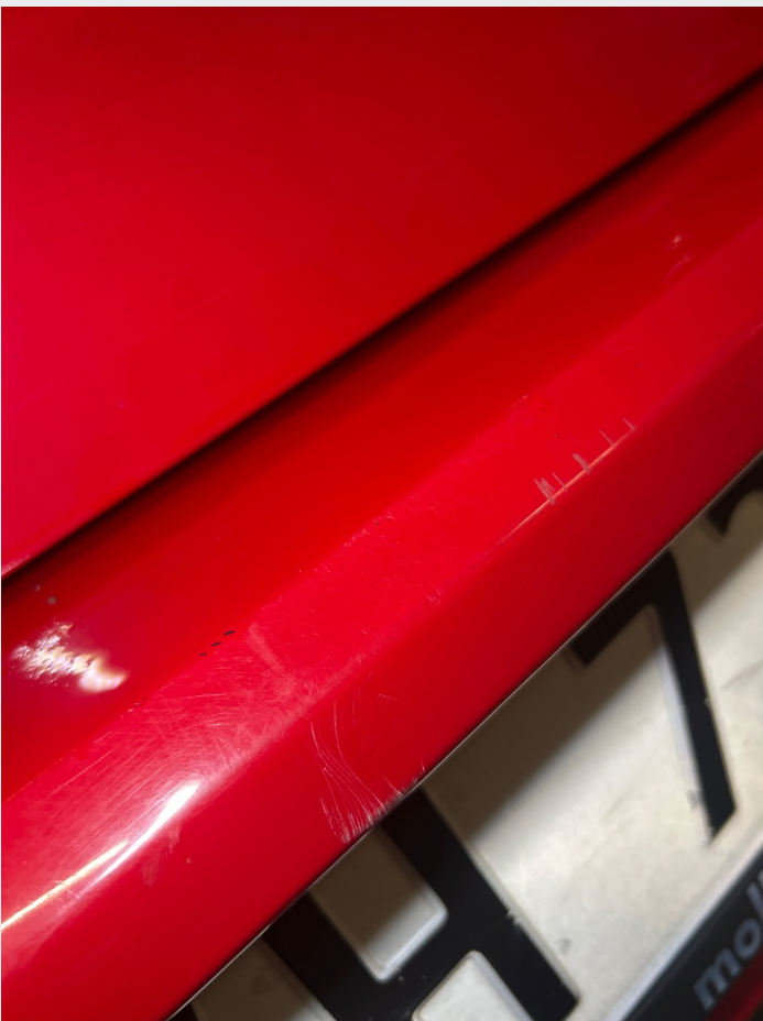
2.1 En del steinsprut og riper rundt om
