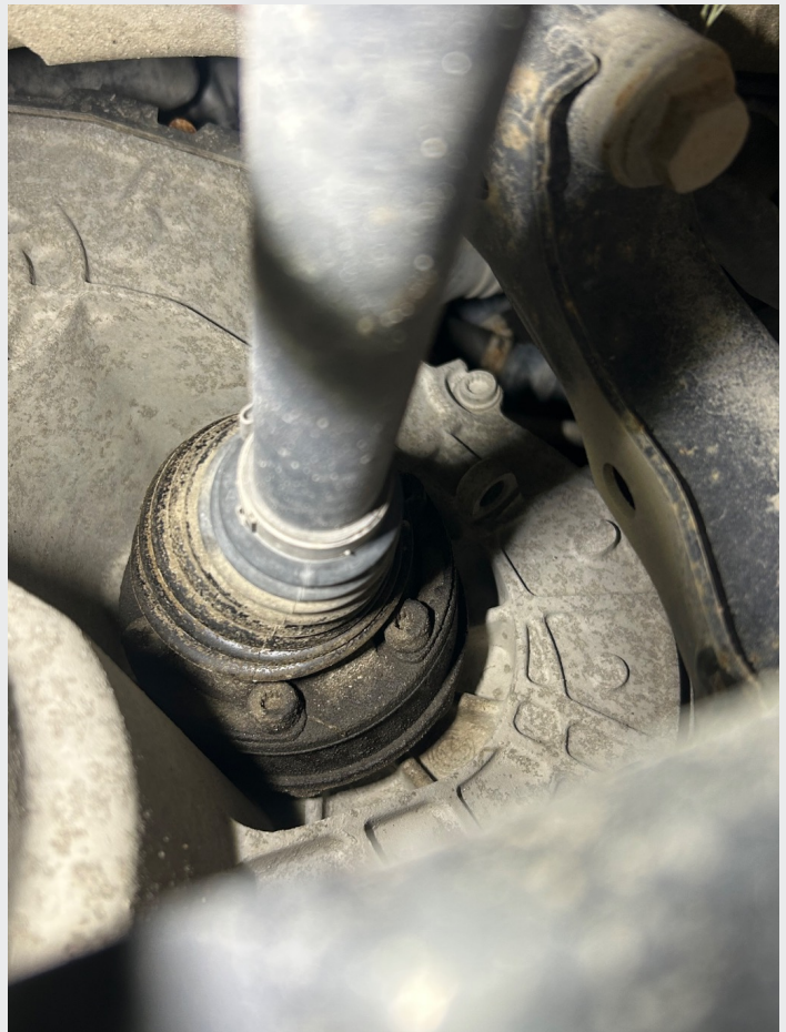
7.1 Svetting simmering girkasse - drivaksel begge sider
