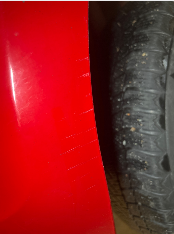
2.1 En del steinsprut og riper rundt om
