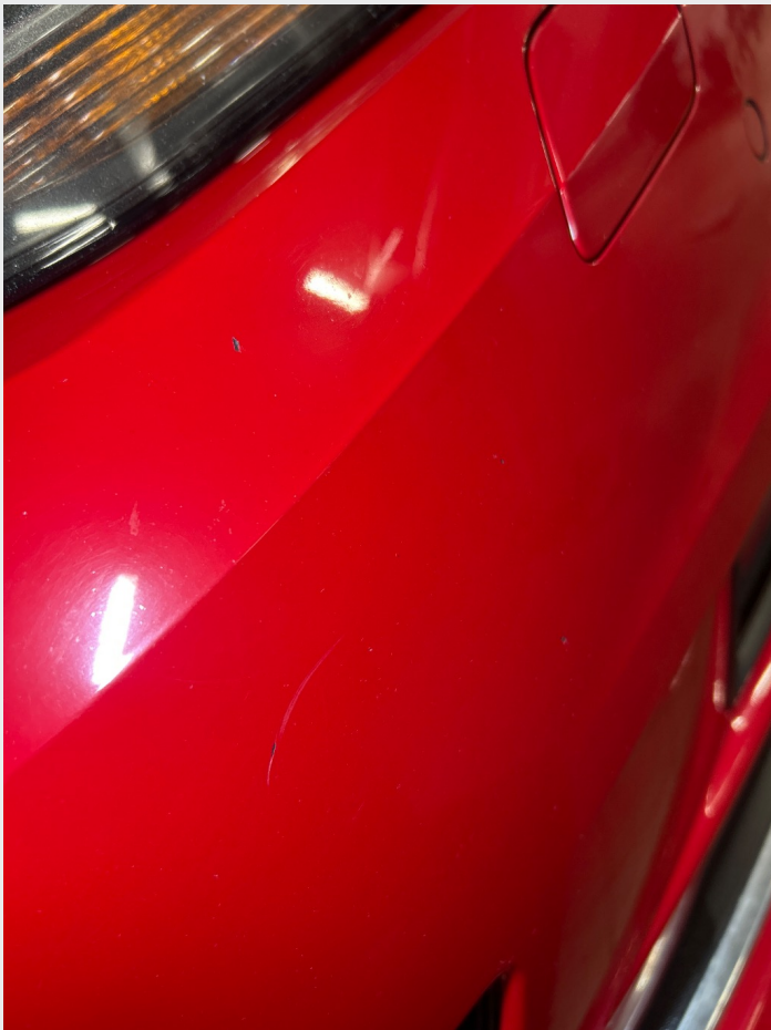
2.1 En del steinsprut og riper rundt om
