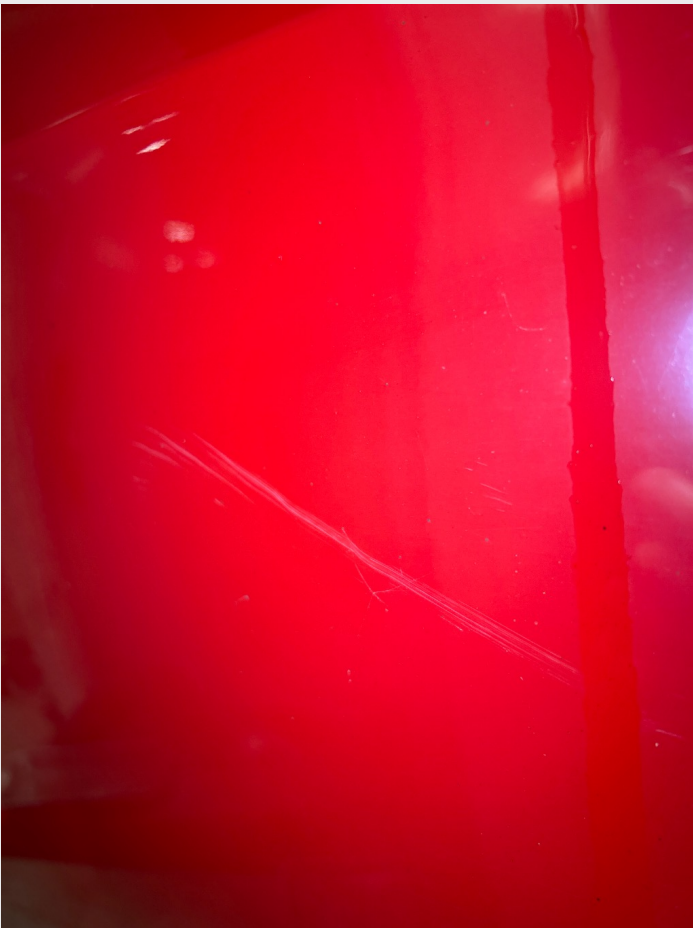
2.1 En del steinsprut og riper rundt om
