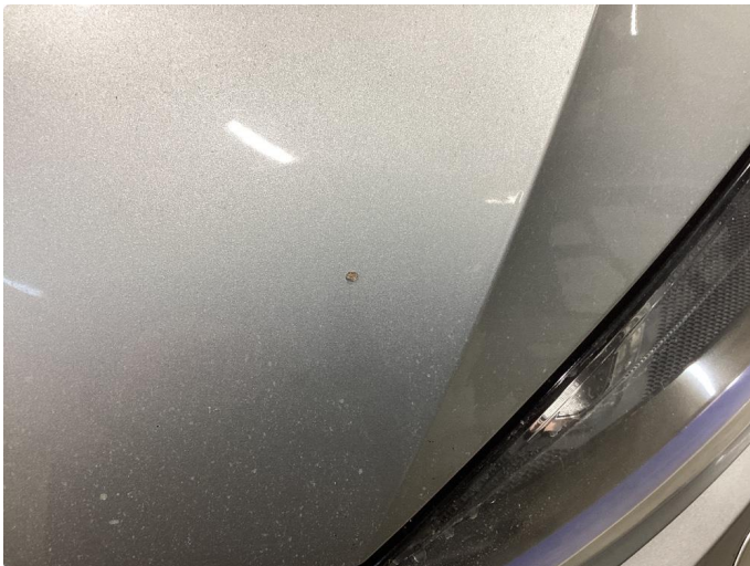
2.1 Noe steinsprut med rust
