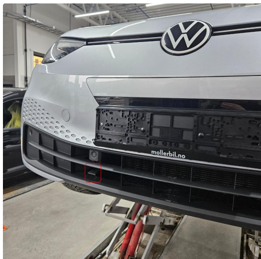
1.1 Mangler en plast-spile, h.side i nedre grill, frontfanger
