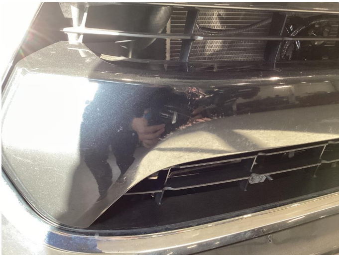
1.2 Rust + riper på foran Støtfanger
