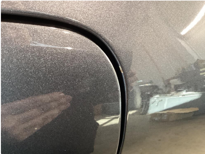
1.1 Fuel cap - riper med rust
