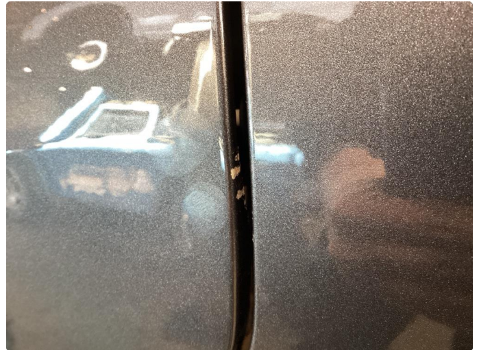
1.1 Fuel cap - riper med rust
