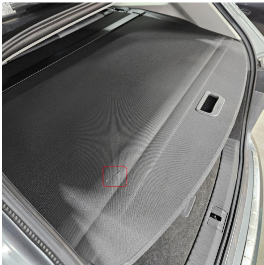
2.1 Rift på v.side av rollo/bag.romskjuler
