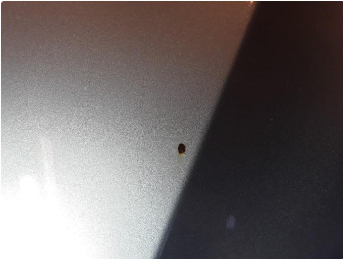
1.2 Noe steinsprut med korrosjon.
