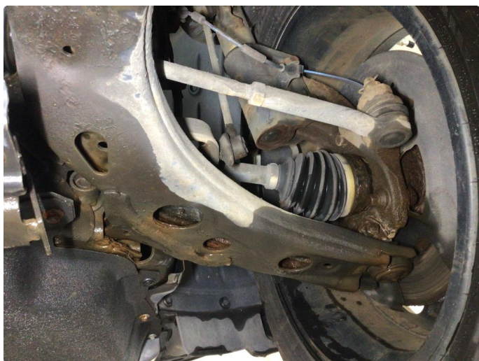
2.1 Overflaterust i forstilling, ingen tiltak kreves
