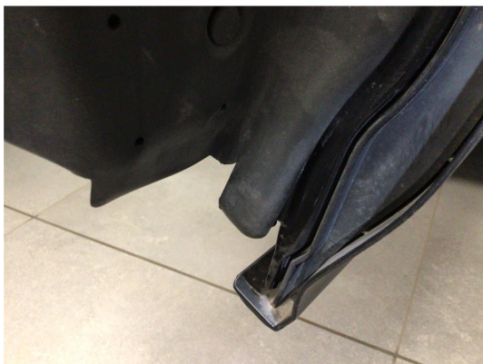
1.1 Minimalt med korrosjon i nedre kant av begge bakhjører er utbedret med pensellakk
