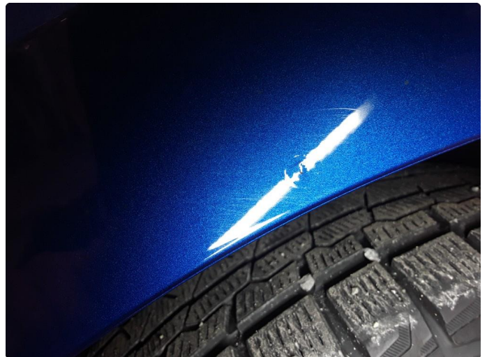
1.4 Liten steinsprut med korrosjon.
