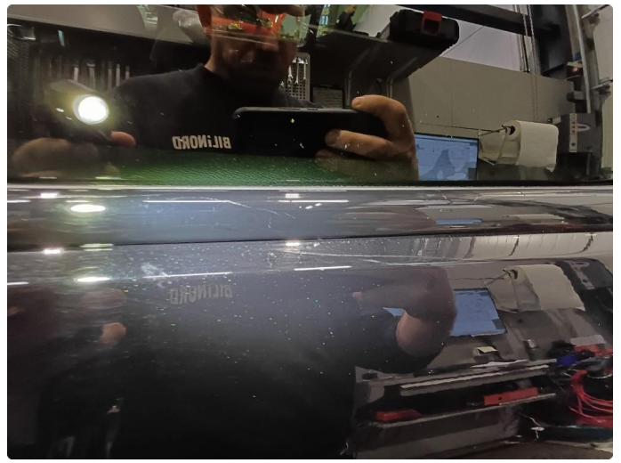
1.1 Noen riper og småbulker
