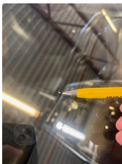
2.5 Steinsprut med sprekk
