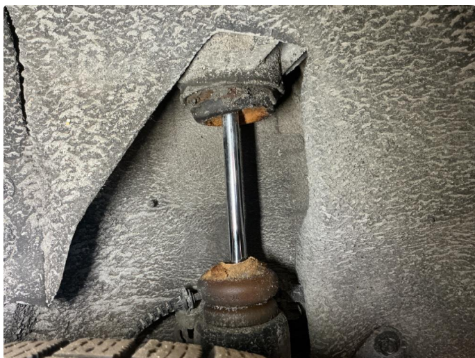
4.3 Støvmansjett bak skiftet på begge bakhjulene
