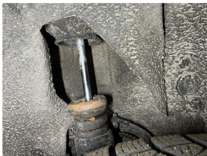
4.3 Støvmansjett bak skiftet på begge bakhjulene
