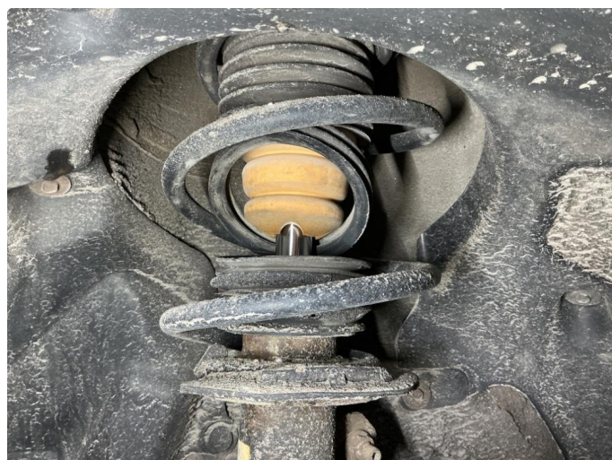
4.2 Støvmansjett foran skiftet begge forhjulene
