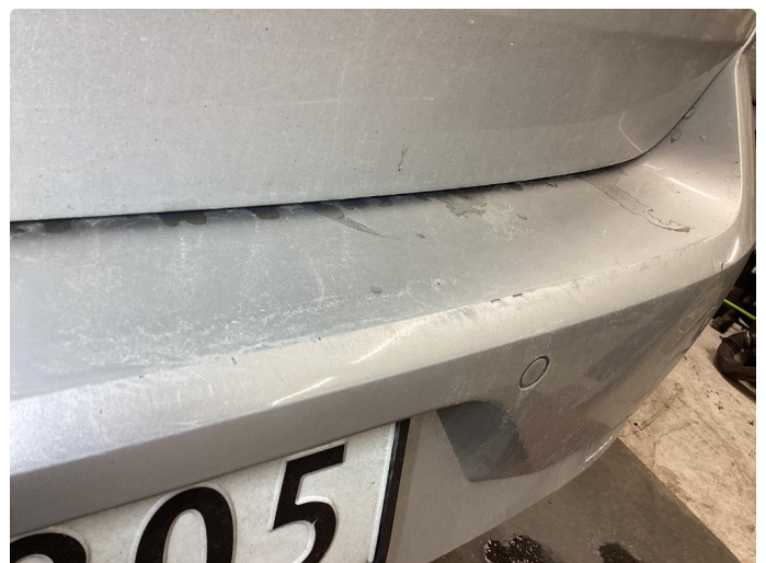
1.6 Riper innlastnings området bak
