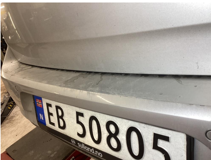
1.6 Riper innlastnings området bak
