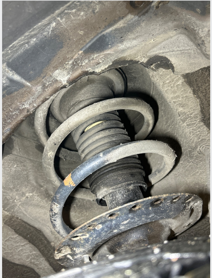
8.6 Revnet mansjett på støtdempere foran
