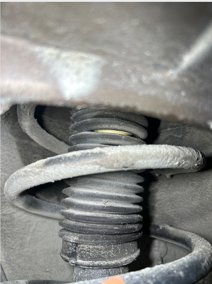
8.6 Revnet mansjett på støtdempere foran
