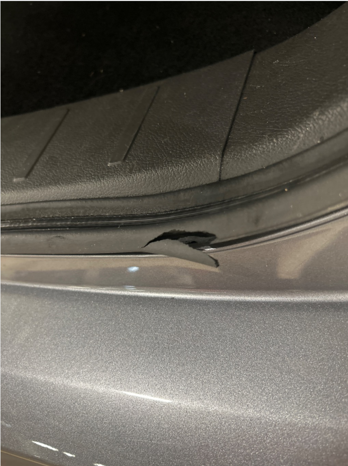
2.5 En revnet bit på pakning mot bakluke
