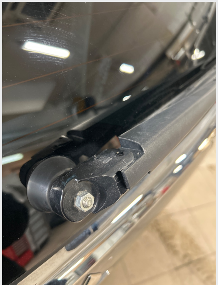
2.16 Deksel over festemutter til bakrutevisker mangler
